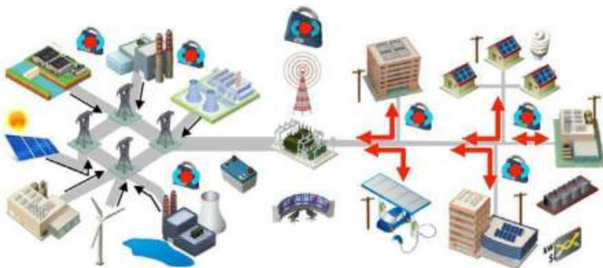
Figura 6: Una red eléctrica inteligente requiere flujo de energía bidireccional.
